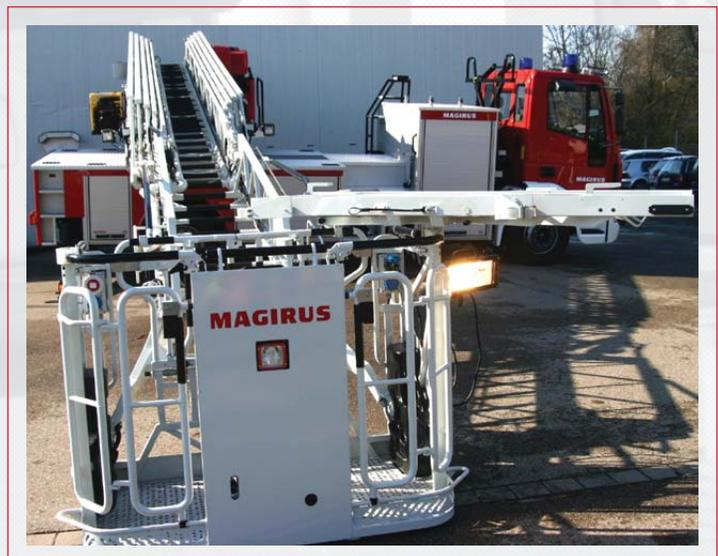
Wie auch am Hauptbedienstand ist der Rettungskorb mit einem Farbbedienfeld mit Klartextanzeige ausgestattet. Die Leiter kann vom Korb aus bedient werden.
