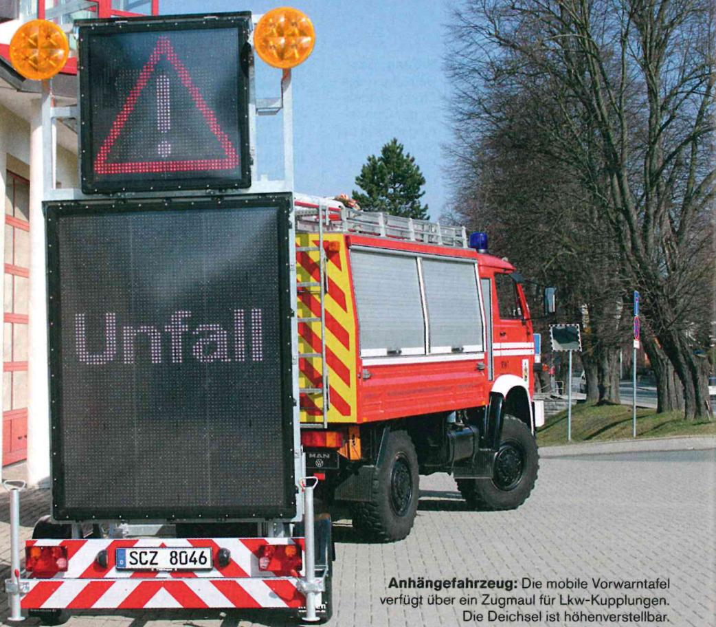
**Anhängerfahrzeug:** Die mobile Vorwarntafel verfügt über ein Zugmaul für Lkw-Kupplungen. Die Deichsel ist höhenverstellbar.
